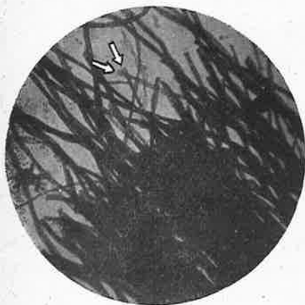
FIG. 9 et 10. Fil tendu, couteau aiguisé. Elargissement minime et régulier des extrémités. Le fil montre une coupure relativement nette (la fig. 10 montre nettement la partie coupée et celle où les fibres affaiblies par la tension se sont déchirées d'elles-mêmes).
